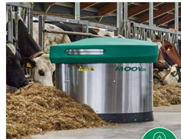
Der umweltfreundliche Elektroantrieb an sich bietet bereits eine hohe Energieeffizienz. Zudem kann der Moov 2.0 in Kombination mit einer Photovoltaik-Anlage besonders energiesparend eingesetzt werden.
