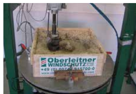
Kalottentest zu Verformbarkeit/Dauertrittbelastung
